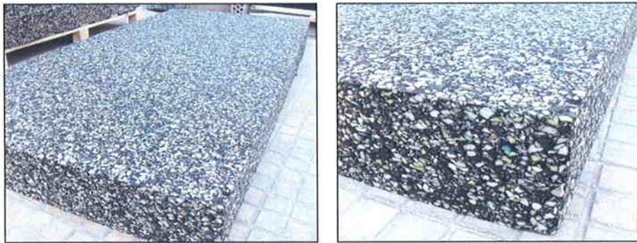
Imágenes 1 y 2 Detalles del panel Copopren ® Acústico Negro de 140 mm
